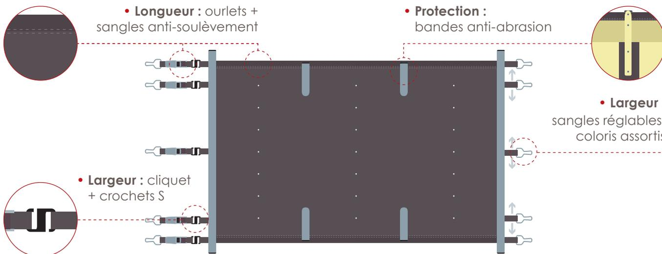
Les couvertures à barres Securit Pool **Access** sont conçues à partir de tissu enduit PVC 580 g/m<sup>2</sup> et composées d'un système de maintien au moyen de barres en aluminium anodisé. Elles sont dotées de cavités pour l'évacuation des eaux pluviales et sont livrées avec une manivelle manuelle démultipliée.
